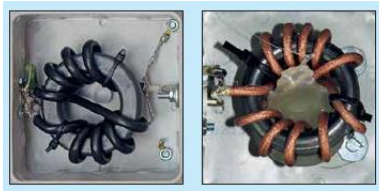
Fot. 2.3.4. Dławiki W1JR, po lewej Aircell 5 na rdzeniu FT240-43, po prawej RG316 na rdzeniu FT140-43
