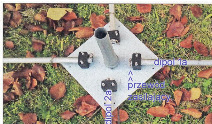
Fot. 5.15.1. Sposób umocowania dipoli. Środkowa rura służy do umocowania podstawy na maszcie, a więc odcinki dipola znajdują się u dołu. Końce kabli umieszczono w puszcze plastikowej od instalacji elektrycznych znajdującej się po drugiej stronie podstawy, czyli u góry. Z puszki wyprowadzone są też przewody połączeniowe do połówek dipoli przechodzące przez otwory w podstawie i podłączone do rurek aluminiowych za pomocą śrubek
